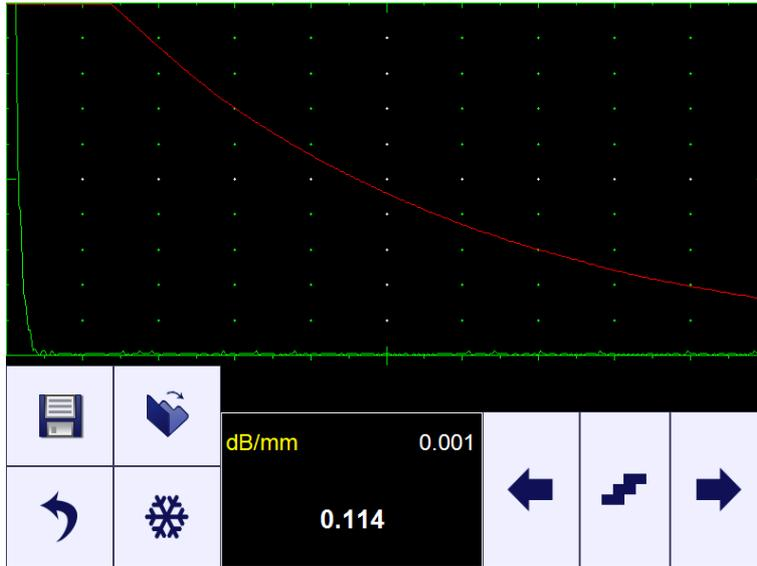
理论 DAC 是指随着距离的增加缺陷的反射幅度完全按照指数型衰减的曲线；缺陷由 dB/mm (dB/in) 衰减系数及探头延时（参照操作手册 5.7.1 节）来确定；在材料表面即零点位置理论 DAC 曲线的 A 扫描幅度为 100%。点击 **dB/mm** 输入材料衰减系数 dB/mm (dB/in)。点击 **dB/mm**，将衰减系数 dB/mm (dB/in) 调为 0 来删除理论 DAC 曲线。
