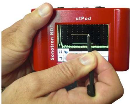
点击 **Draw A** (闸门 B (Gate B) 绘制方法相同), 可在新的所期望的位置绘制闸门 A (Gate A) (或者闸门 B (Gate B))。此种方法可以快速重新定义闸门的三个参数。
